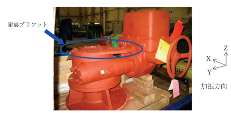
別紙 2-5-1-10 図 二次減速機付き電動弁駆動部（補強後）
