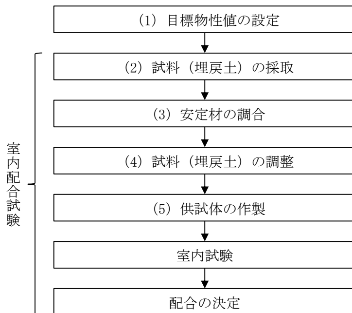
図 4.6.1-1 室内配合試験におけるフロー
