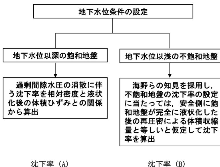
図 3-1 沈下量の算定方法
