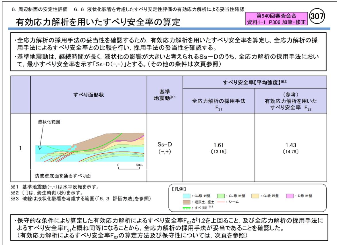
図 2.9.6-3 全応力解析と有効応力解析の比較
