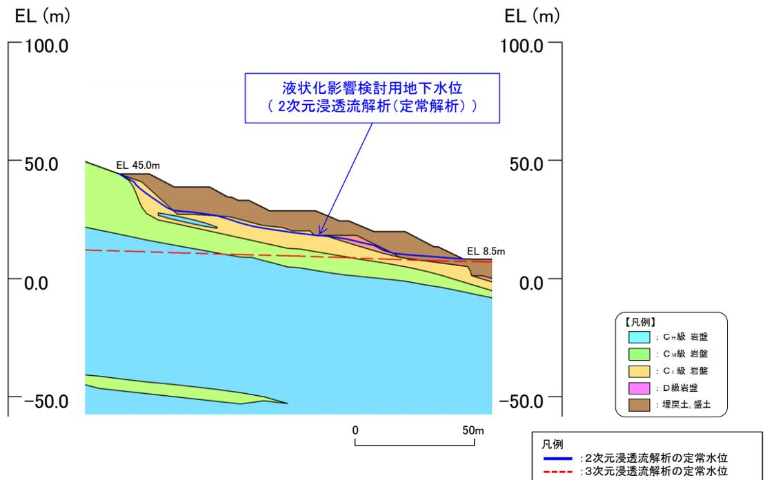
図 2.8.2.1-4 2次元浸透流解析結果
