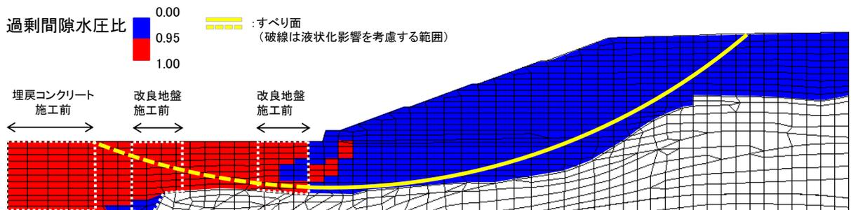
注：過剰間隙水圧比分布は、 $S_s - D$ の各地震動方向における最大過剰間隙水圧比分布図が 0.95 を超えた要素を包絡するように設定している。
