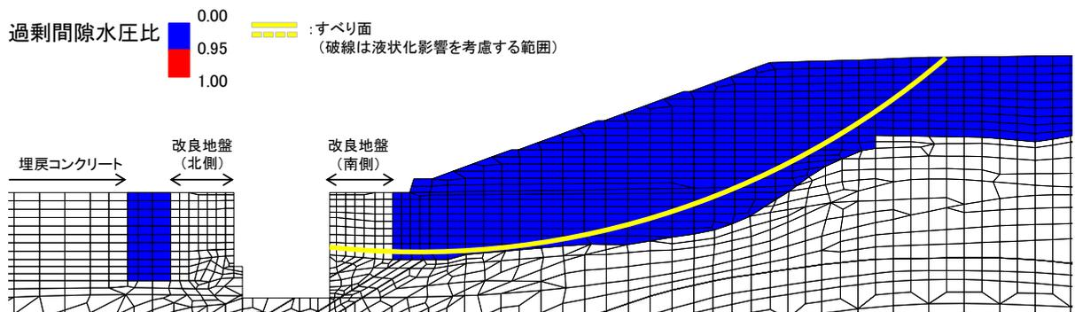
図 2.9.8-5 過剰間隙水圧比分布図（2号機南側盛土斜面（⑧-⑧'断面））
