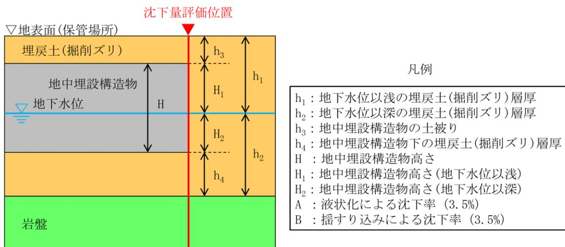
地盤の沈下量  $\delta_1$  :  $\delta_1 = h_1 \cdot B + h_2 \cdot A = h_1 \cdot 3.5\% + h_2 \cdot 3.5\% = (h_1 + h_2) \cdot 3.5\%$
