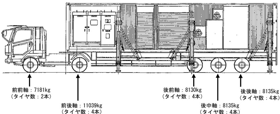
図5-1 移動式代替熱交換設備の仕様
