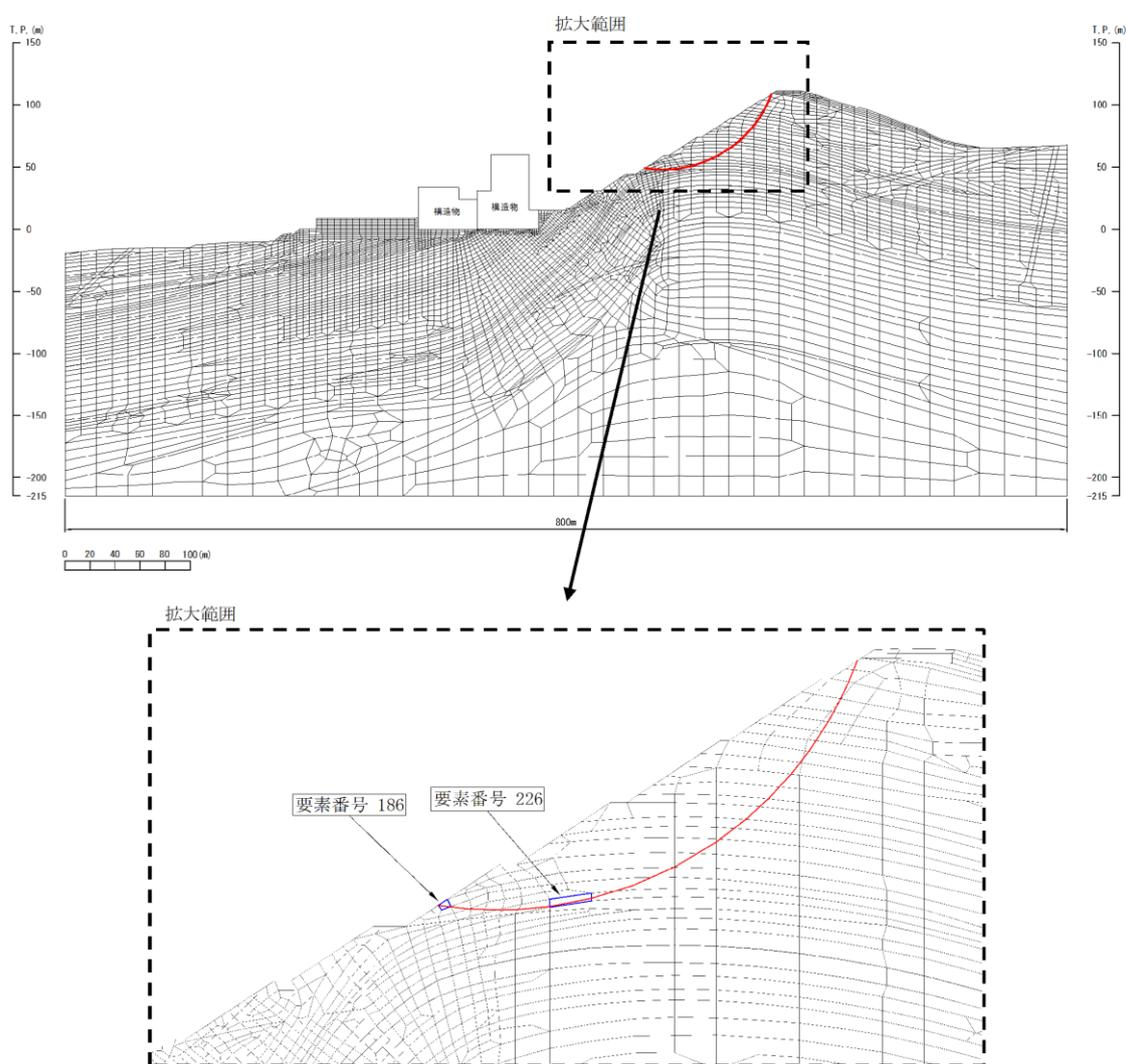
図3 解析モデル及び検証用すべり線
