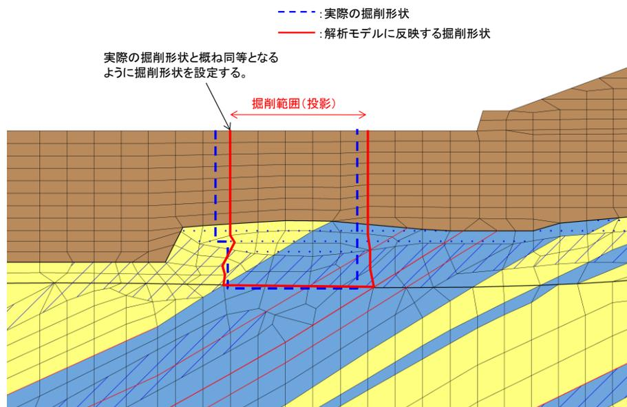
図 2.9.5-7 掘削形状の反映方法
