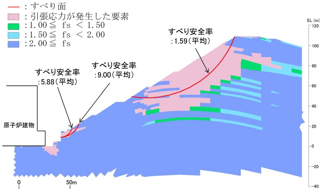
図 2.9.7-1 局所安全係数分布図（2号機南側切取斜面（④-④'断面））
