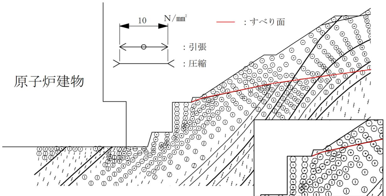
図 2.9.7-3 主応力図（2号機南側切取斜面（④-④'断面））
