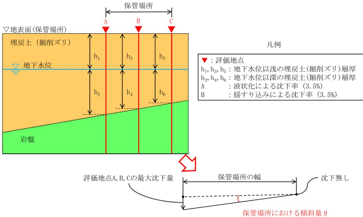
評価地点 A の沈下量  $\delta_A$  :  $\delta_A = h_1 \cdot B + h_2 \cdot A = h_1 \cdot 3.5\% + h_2 \cdot 3.5\% = (h_1 + h_2) \cdot 3.5\%$
