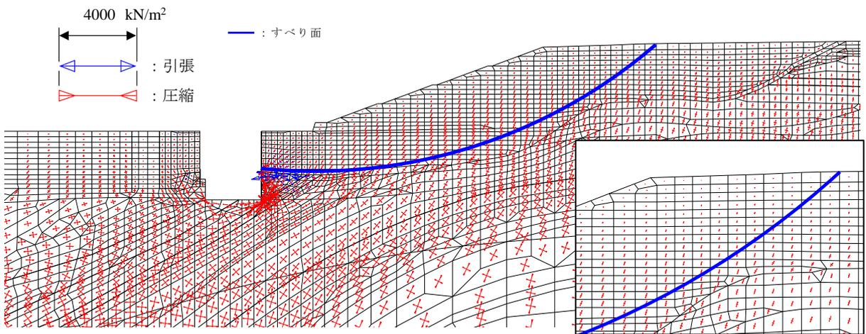
図 2.9.8-3 主応力図（2号機南側盛土斜面（⑧-⑧'断面））
