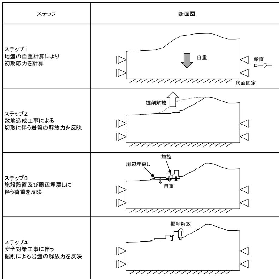
図 2.9.4-2 常時応力解析のステップ図
