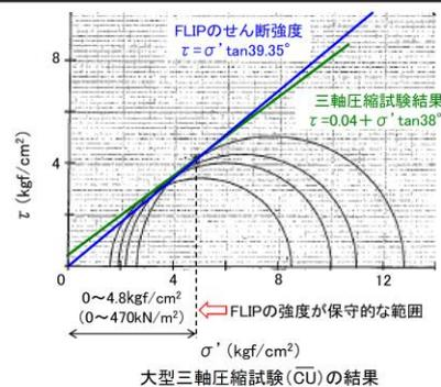
図 2.9.6-5 全応力解析と有効応力解析の比較
