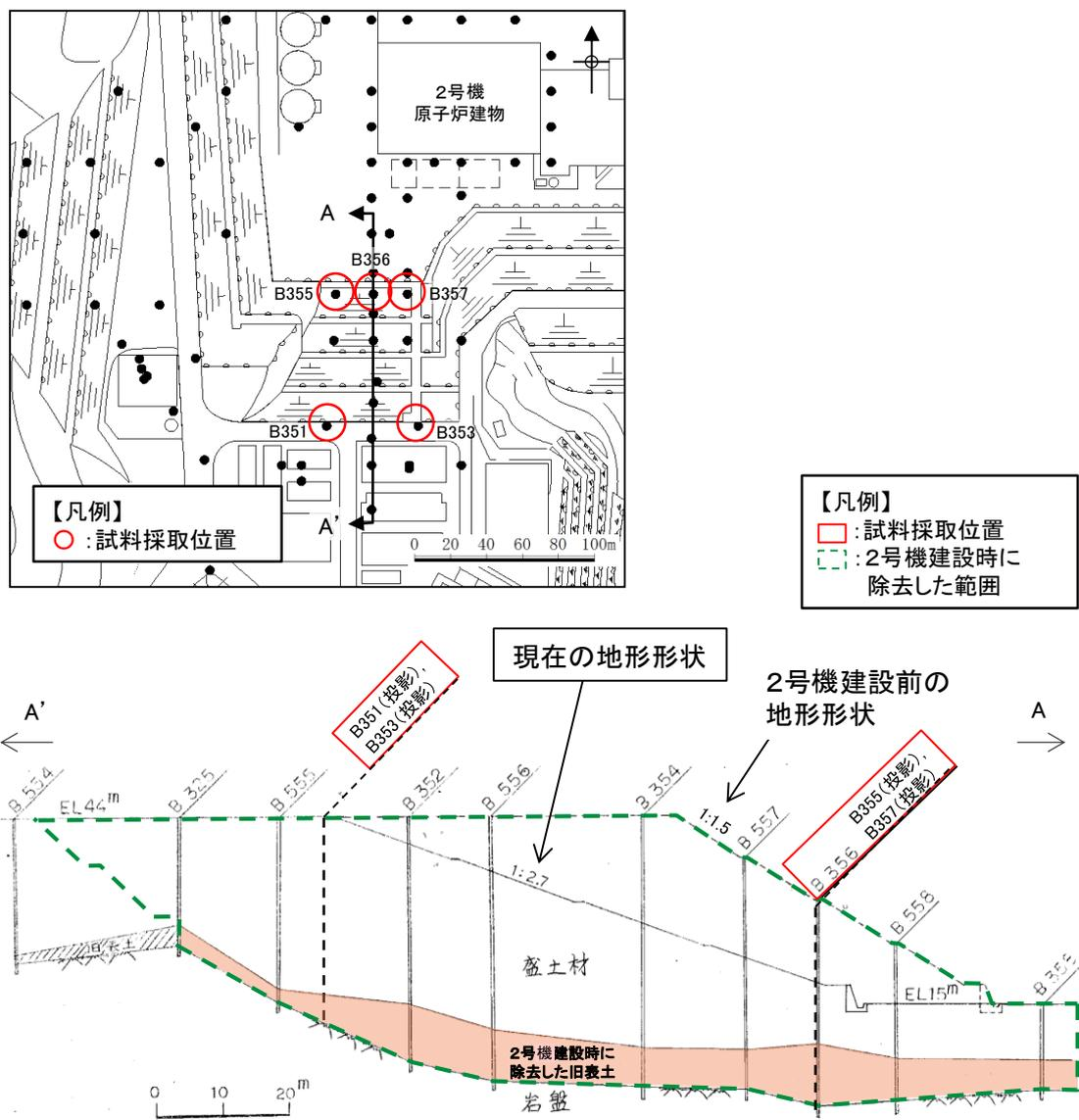
図2 試料採取位置図 (旧表土)
