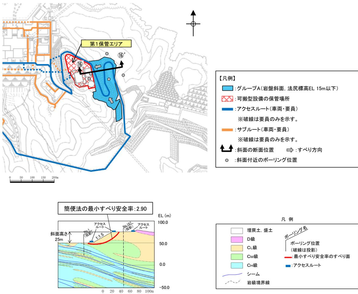
図 12 ⑩-⑩' 断面の比較結果
