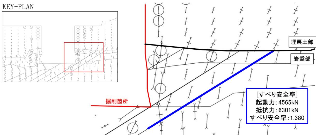
図 2.9.5-11 掘削箇所近傍を通るシームにおけるすべり安全率
