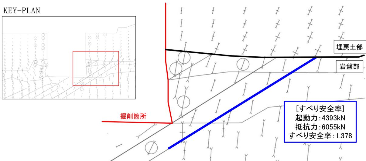
図 2.9.5-10 掘削箇所近傍を通るシームにおけるすべり安全率
