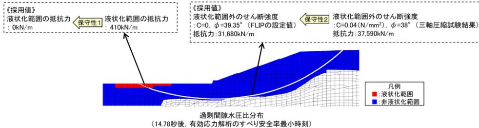
図 2.9.6-4 全応力解析と有効応力解析の比較
