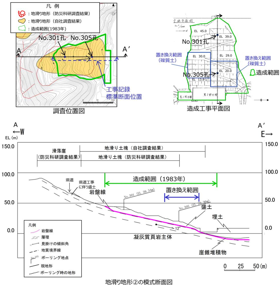
図 2.8.2.1-2 地滑り地形②の模式断面図
