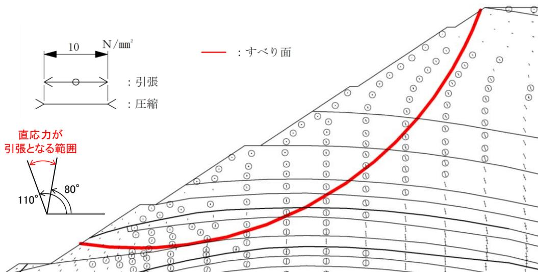
図 2.9.7-2 主応力図 (2号機南側切取斜面 (④-④' 断面))
