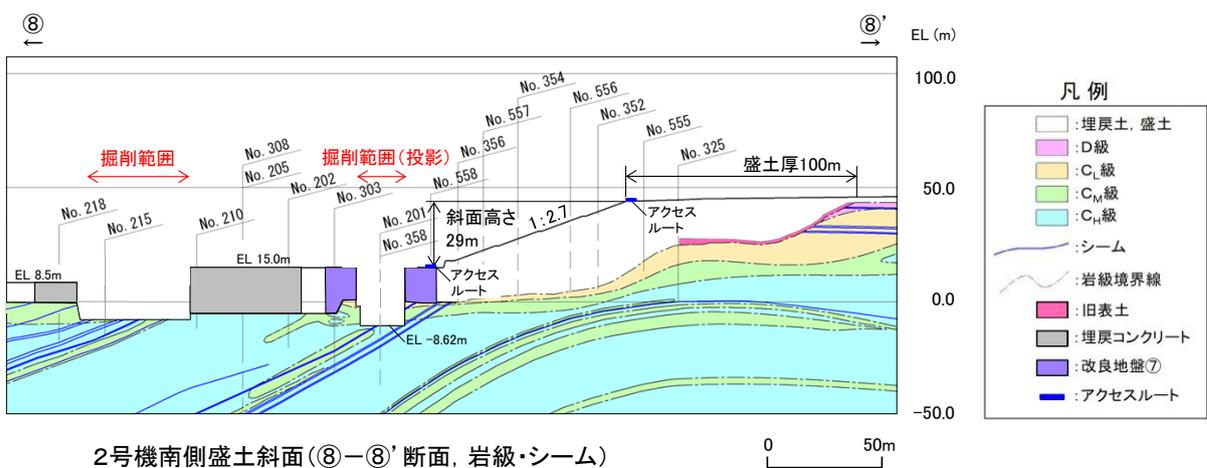
図 2.9.3-6 評価対象斜面図（掘削箇所投影）
