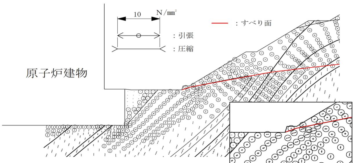
図 2.9.7-4 主応力図（2号機南側切取斜面（④-④'断面））
