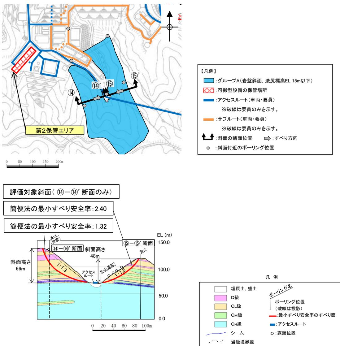
図 11 ⑭-⑭' 断面及び⑮-⑮' 断面の比較結果
