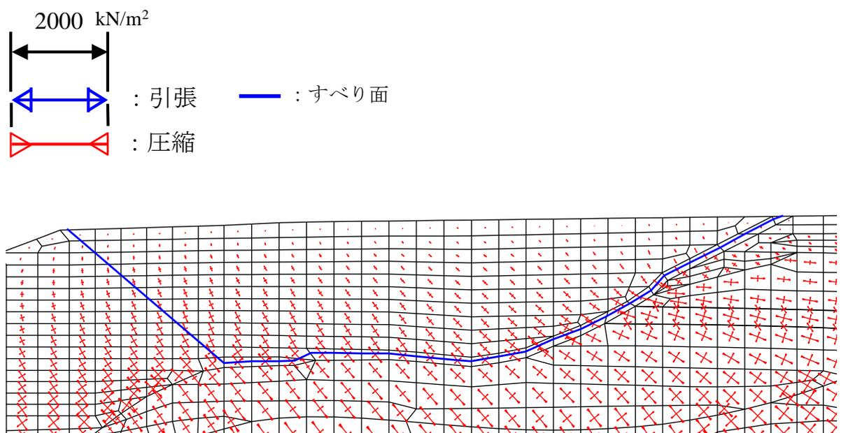
図 2.9.8-2 主応力図 (2号機南側盛土斜面 (⑧-⑧' 断面))
