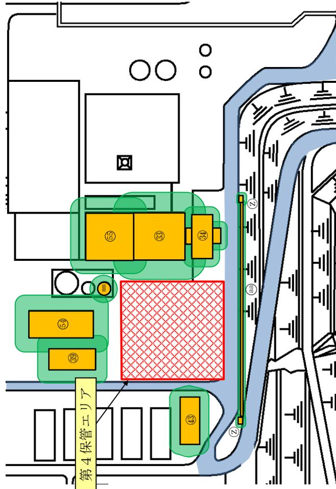
図 6-13 建物等倒壊時の保管場所への影響評価結果（第4保管エリア）
