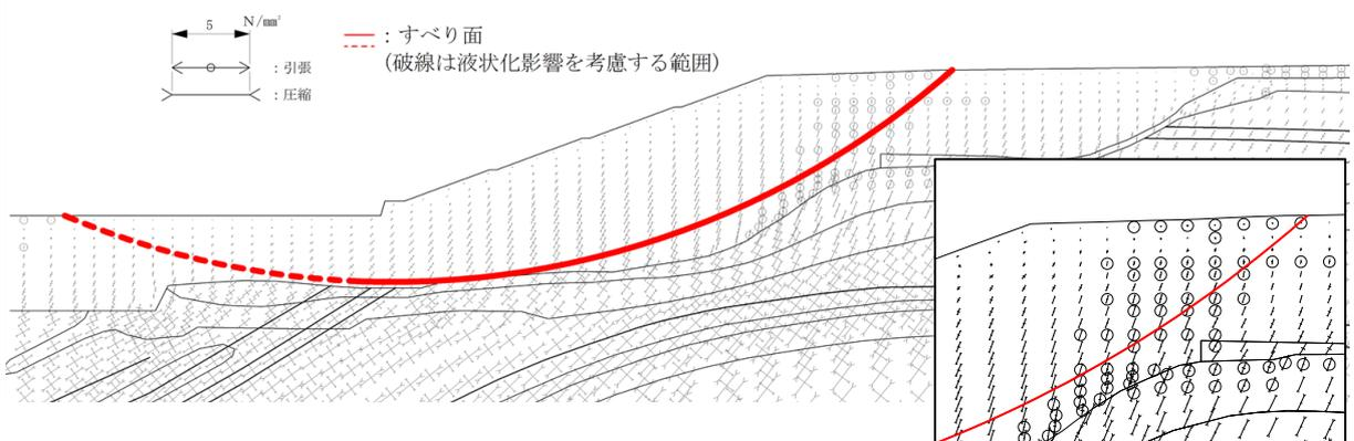
図 2.9.8-4 主応力図（2号機南側盛土斜面（⑧-⑧'断面））
