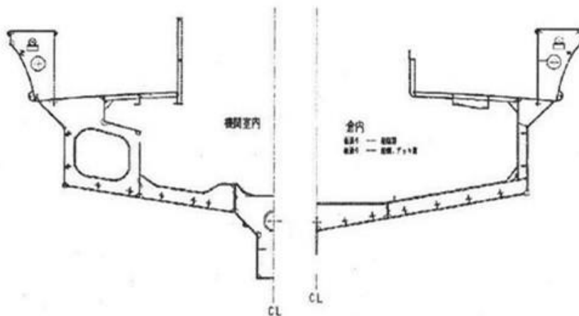
図-2.2 アルミ合金漁船の中央断面図
