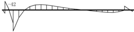
数值：評価位置における断面力 (a) 曲げモーメント (kN・m)
