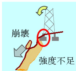
【急傾斜地の崩壊】
