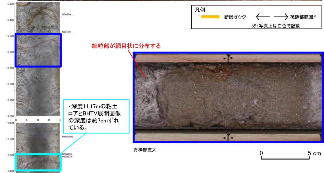
・深度11.17mの粘土コアとBHTV展開画像の深度は約7cmずれている。
