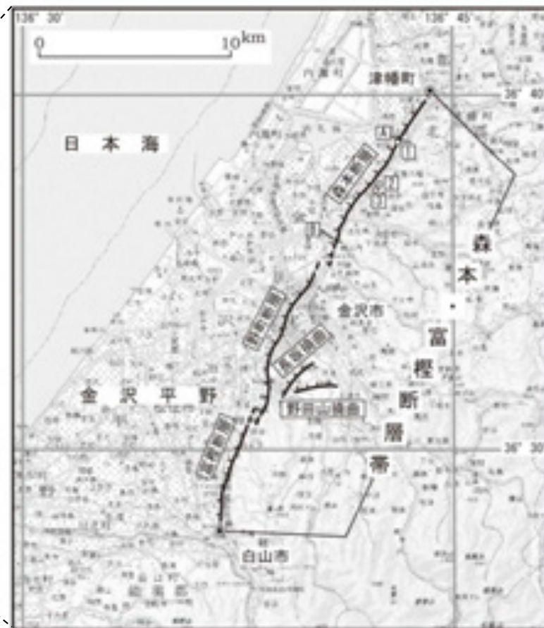
図2 森本・富樫断層帯の活断層位置と主な調査地点 1: 利根地点 2: 梅田北地点 3: 梅田南地点 A, B: 反射法弾性波探査測線 ●: 断層帯の北端と南端 活断層の位置は東郷ほか(1998a, b)及び東郷(2000)に基づく。 基図は国土地理院の「数値地図200000(地図画像)」「七尾」及び「金沢」を使用。
