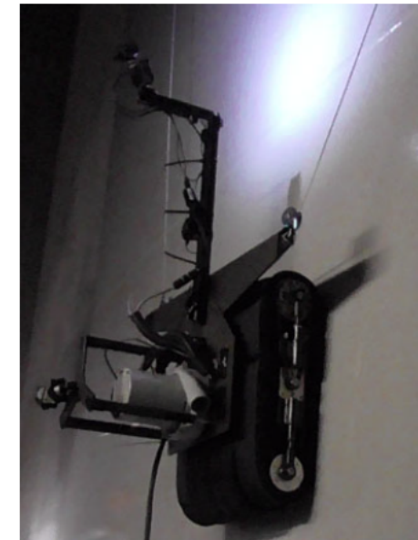
壁面走行ロボット現地写真
