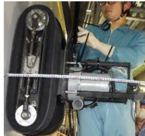
壁面走行ロボット現地写真
