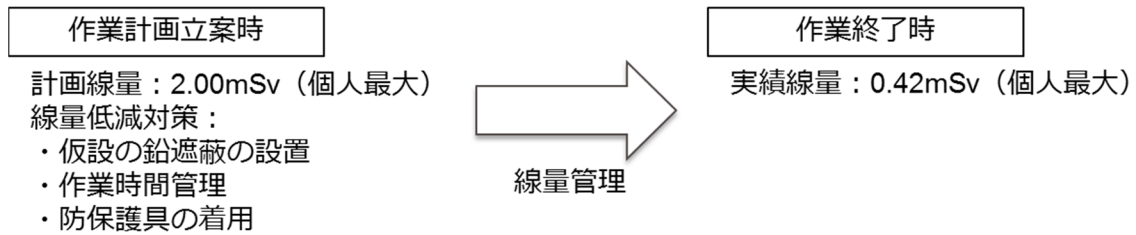
第19図 RCPインターナル除染作業での実績
