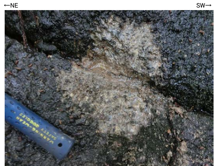
写真⑤-3 走向N75° Eの節理
