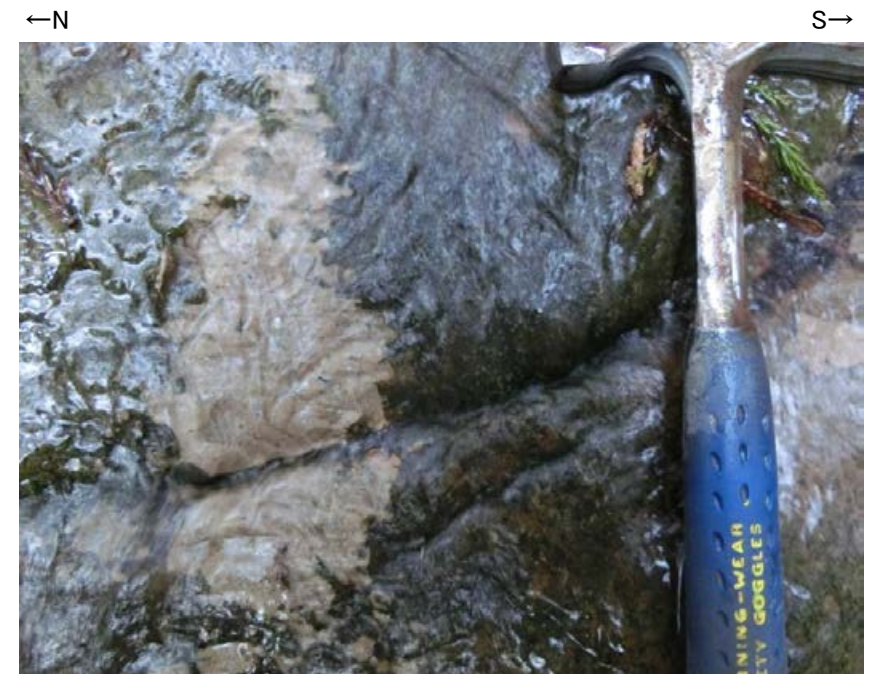
写真④-3 走向N20° Wの節理
