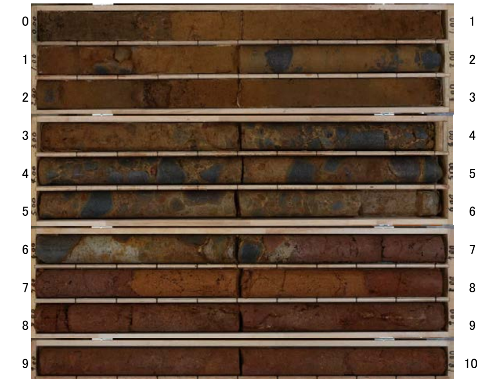
US-N03(孔口標高46.16m, 掘進長10m, 鉛直)
