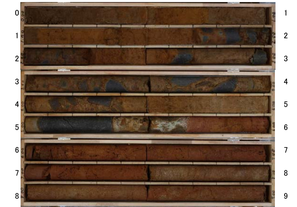
US-N05(孔口標高43.19m, 掘進長9m, 鉛直)
