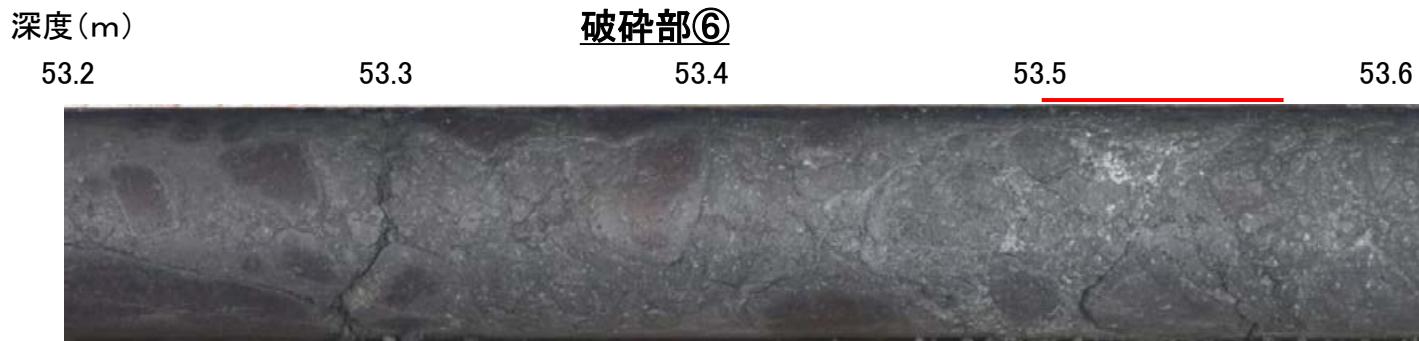
コア写真 ＝ 破碎部 ・厚さ5.7～7.1cmの灰白～暗オリーブ灰色の角礫状破碎部
