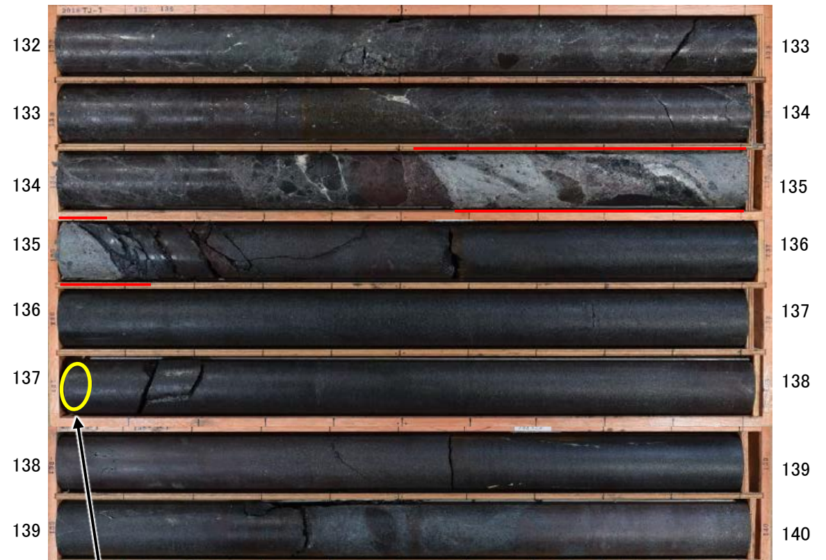
コア写真(深度132~140m) 破砕部
