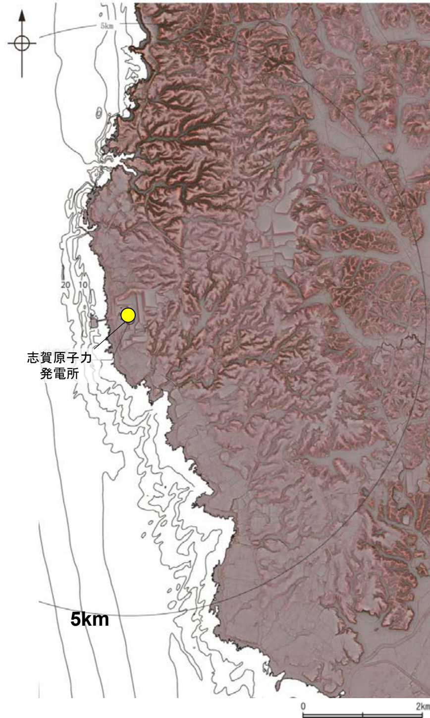
航空レーザー計測による地形データを基に作成した赤色立体地図
