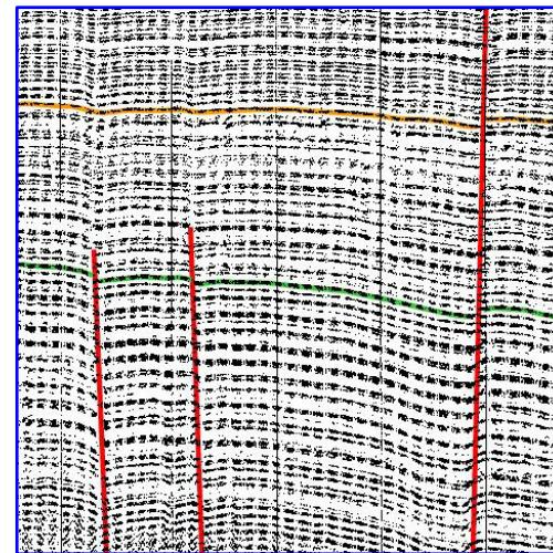
東落ちの東傾斜の断層が推定されることから、正断層であると判断した。
