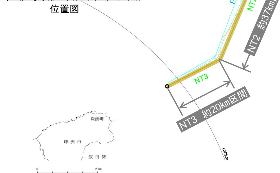
NT3は後期更新世以降の活動が否定できず、その長さとして約20km区間を評価する。
