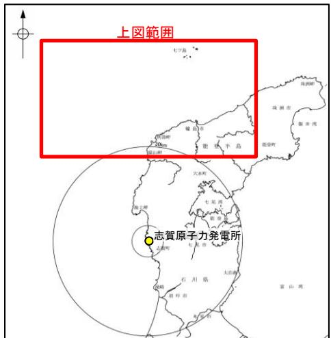
猿山岬北方沖断層は後期更新世以降の活動が否定できず、その長さとして約41km区間を評価する。
