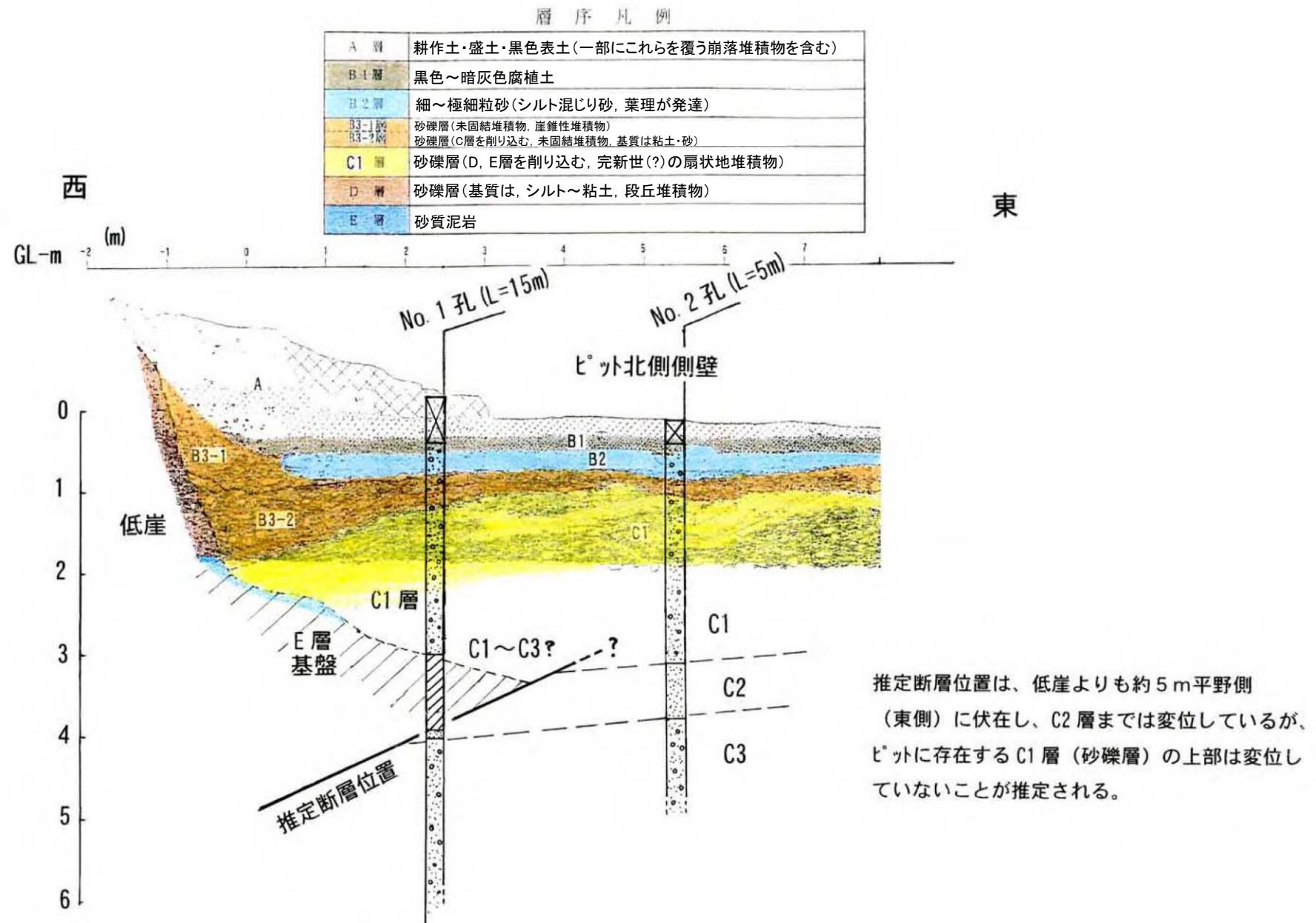
推定断層位置は, 低崖よりも約5m平野側(東側)に伏在し, C2層までは変位しているが, ピットに存在するC1層(砂礫層)の上部は変位していないことが推定される。
