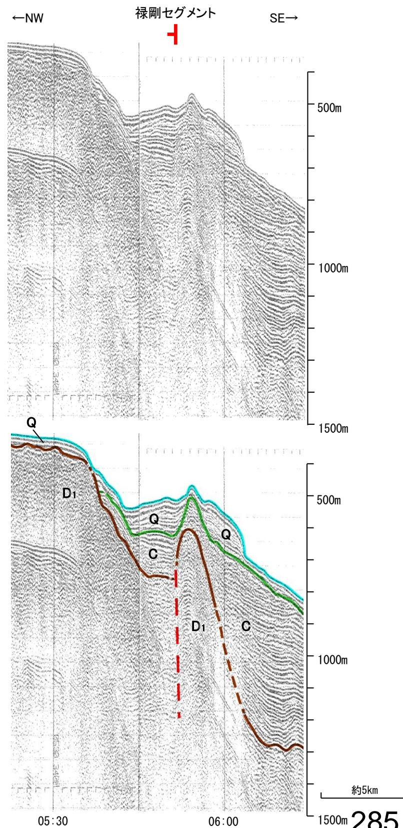
この図面は、地質調査所(現 産業技術総合研究所)の海上音波探査の記録を北陸電力が独自に解析・作成したものである
