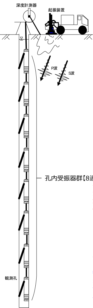
図3 Q値測定概要図
