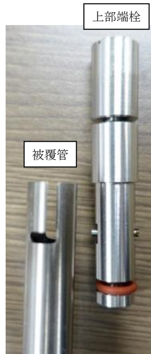
図 1 燃料試料挿入管（試作品）の上部外観
