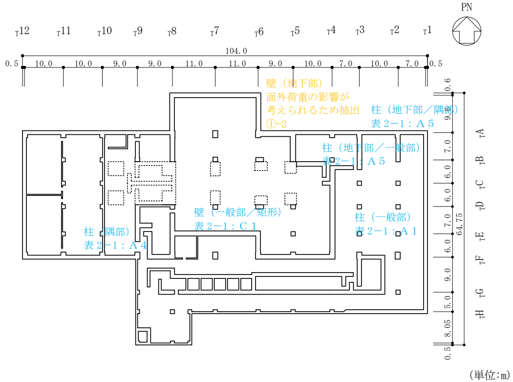
図2-18 1号機タービン建物の概略平面図 (EL 1.8m)
