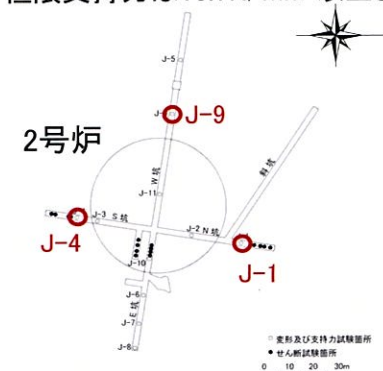
試掘坑内における支持力試験位置
