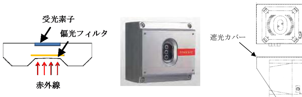
図8 非アナログ式の炎感知器（屋外仕様）の概要
