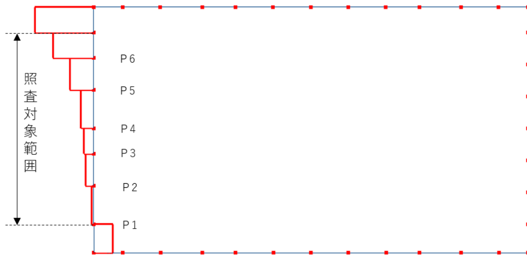
图 4-7 せん断力分布図 (C-C 断面, 側壁)
