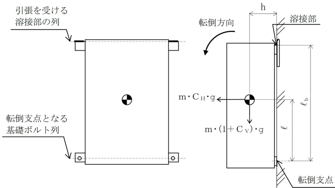
図 5-4 計算モデル (溶接部) (前後方向転倒の場合)
