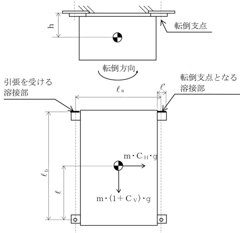
図 5-3 計算モデル (溶接部) (左右方向転倒)
