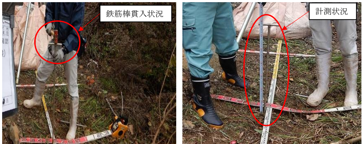
図 2-16 確認試験調査実施状況写真
