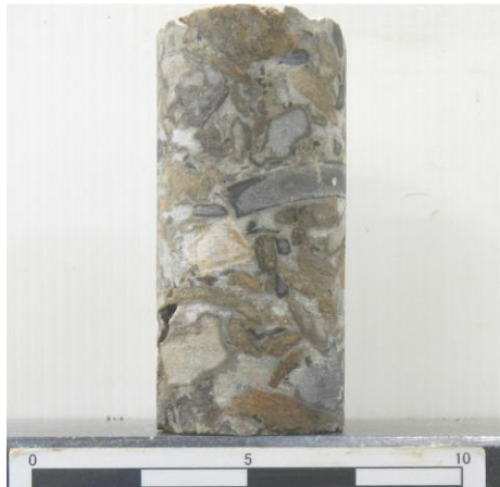
図 4.3.3-3 繰返し三軸試験後の供試体写真（改良地盤⑤）
