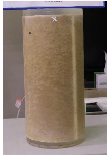
改良地盤⑧の供試体 室内試験実施前の状況写真
