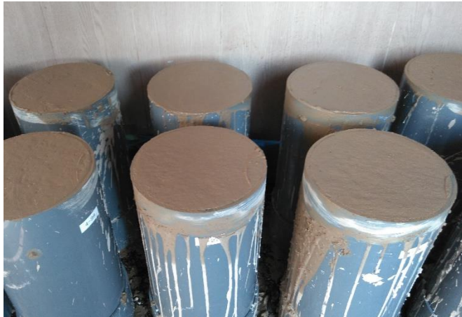
改良地盤⑧の供試体の養生状況 (供試体寸法：直径20cm×高さ40cm)
