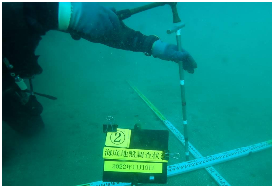
図 2-12 鉄筋棒貫入状況 (ハンマー使用) (参考) 19-11
