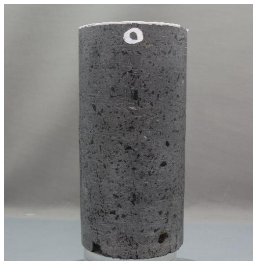
図 4.6.3-3 繰返し三軸試験後の供試体写真（改良地盤⑦）
