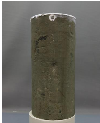
図 2-4 砂礫層における繰返し三軸試験後の供試体写真 (No. 2)
