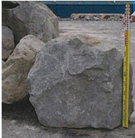
被覆石の寸法（1，2号機北側護岸）
