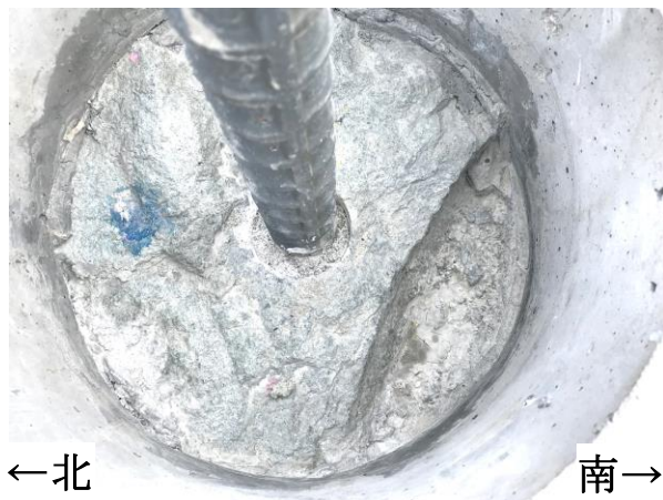
図 4-12(3) 試験後の岩盤状況 (No. D41-3)
