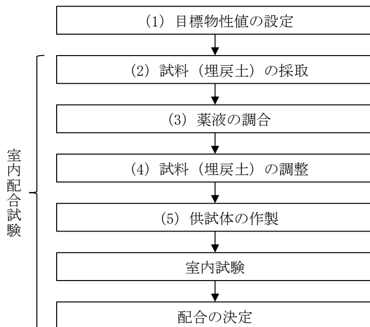
図 4.5.1-1 室内配合試験におけるフロー
