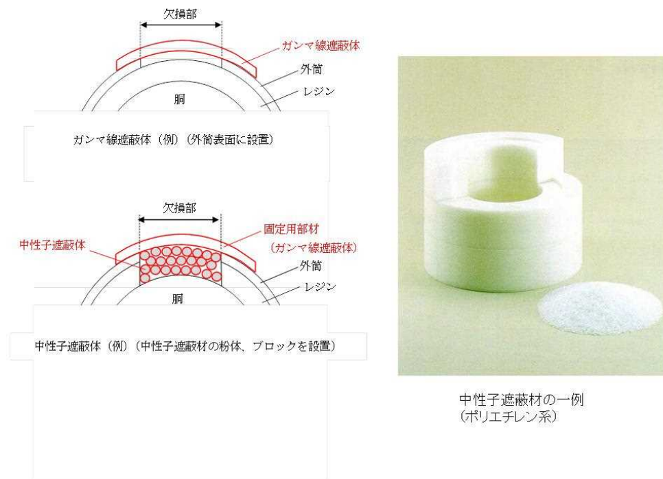
第 6-2 図 衝撃を受けた金属キャスクの追加遮蔽の例
