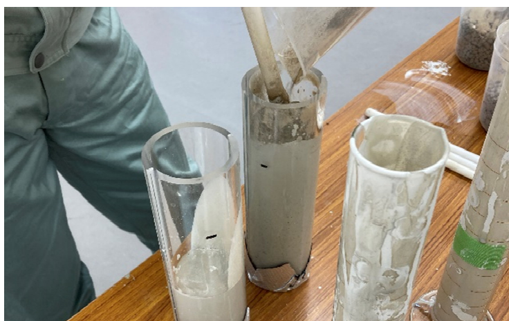
図 4.5.1-5 供試体の作製状況
