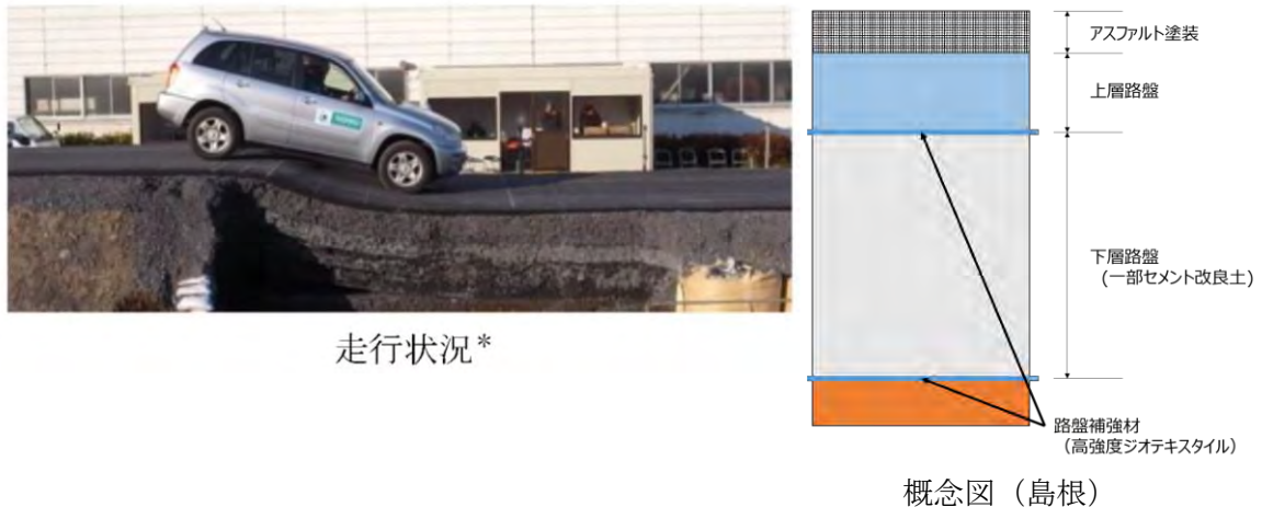
注記*：石垣 勉，尾本 志展，太田 秀樹：アスファルト舗装の地震対策型段差抑制工法に関する実物大実験，第29回日本道路会議，2011 図8-10 路盤補強材（高強度ジオテキスタイル）の概念図
