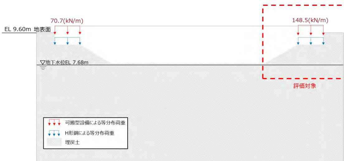
図 2-1 解析モデルの概要図
