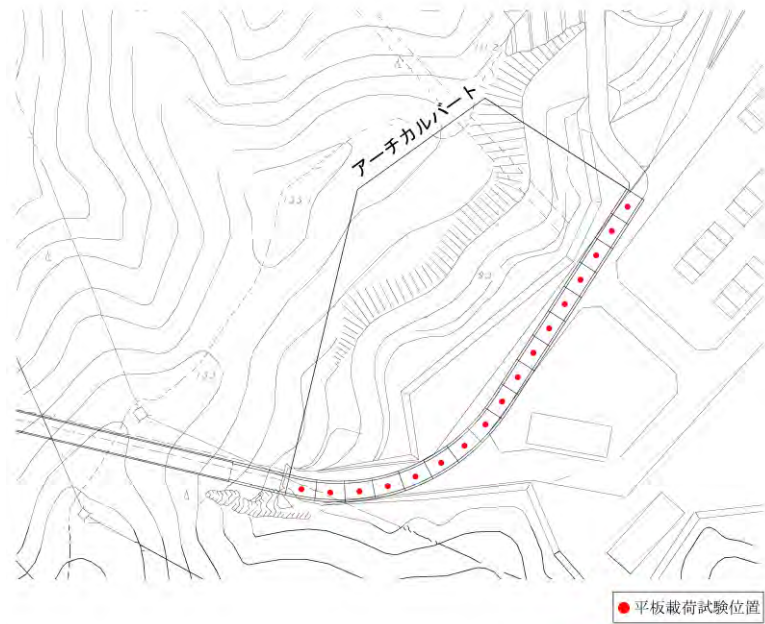
図 7.2.4-7 平板载荷試験の概略平面位置図
