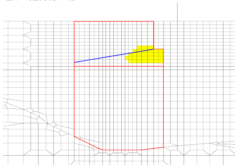
図 6.2-5 改良地盤の最小すべり安全率時刻における局所安全係数分布 ( S_s - N1 (-+) , 解析ケース①, t=7.56s )
