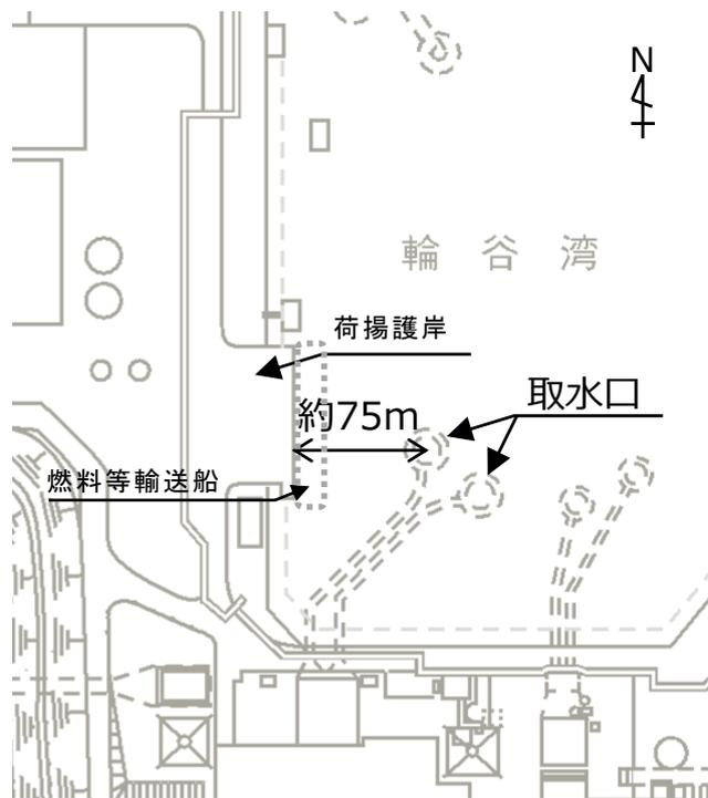
図 2.1-1 係留する船舶・荷揚護岸と取水口の離隔距離
