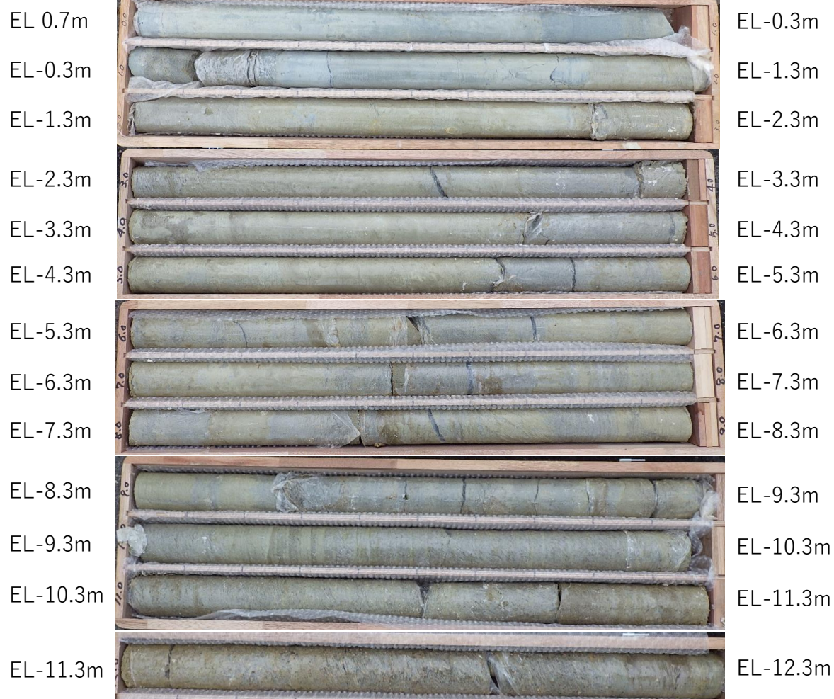
図 4-4 チェックボーリングのサンプリングコア
