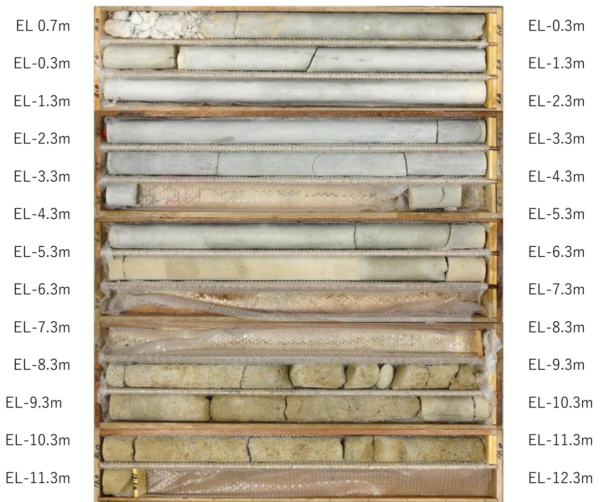
図 3-3 (2) 中詰材改良体 (砂)
