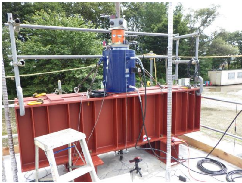
図 3.3-9 模型実験における荷重載荷装置
