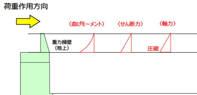
図 4.1.1-22 発生断面力イメージ図
