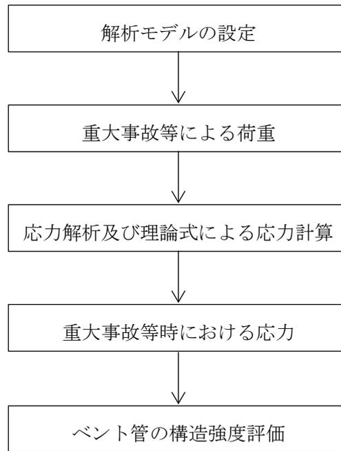
図2-1 ベント管の構造強度評価フロー
