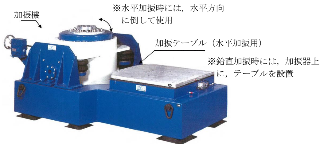
図 2-1 振動試験装置外観
