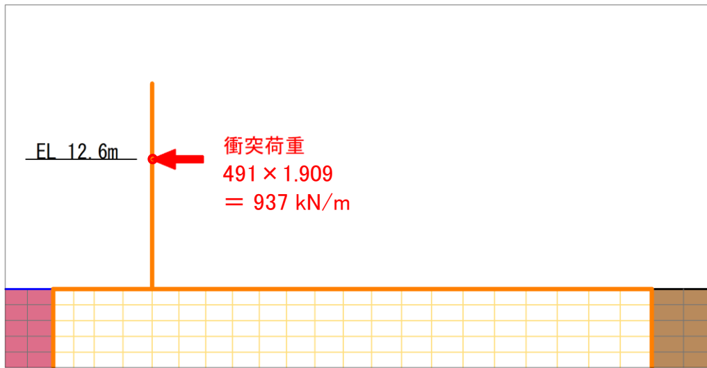
図 3.4.1-2 漂流物対策工における衝突荷重作用図
