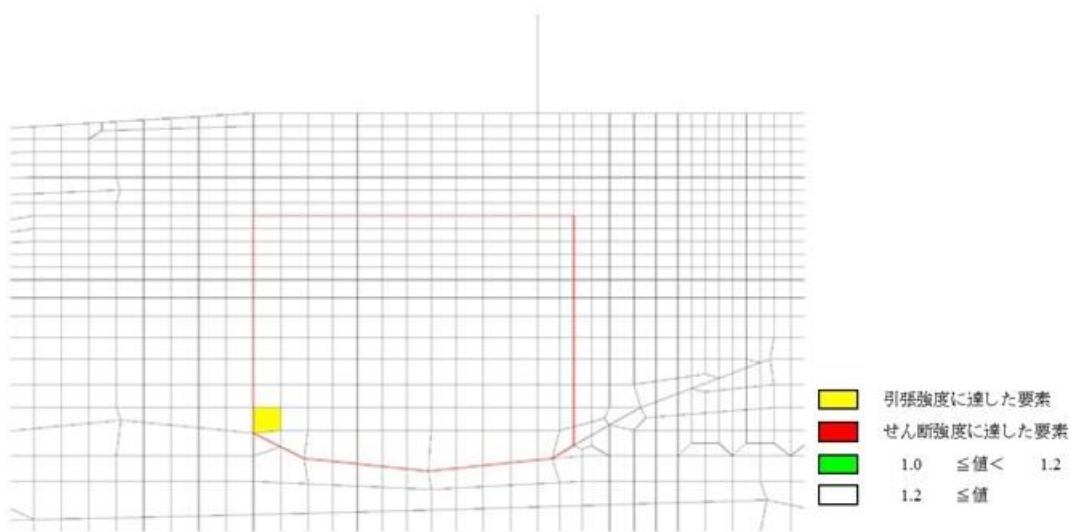
図 6.3-6(2) MMR の引張応力最大時刻の局所安全係数 (S s - D (--), 解析ケース①, t=8.94s)
