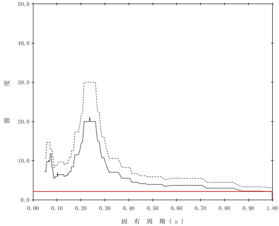
スロッシング評価用床応答スペクトル (ガスタービン発電機用軽油タンク)
