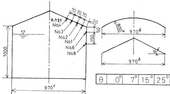
図2 円筒タンク、圧力計配置図
