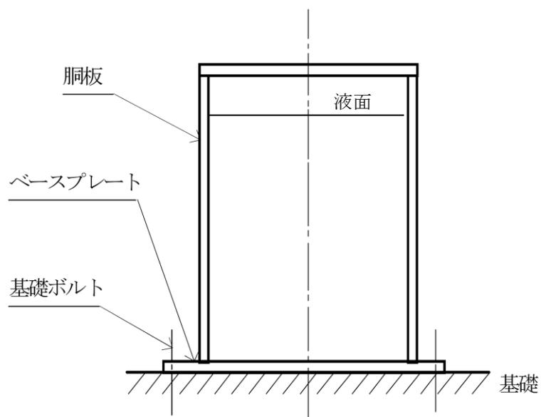
図3 構造概要図（平底たて置円筒形容器）
