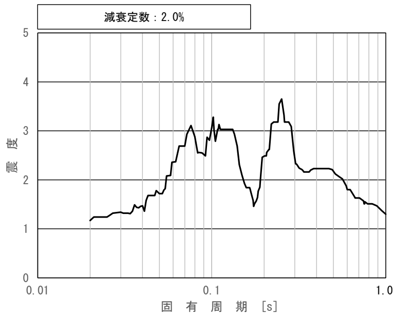
図1 (8/8) 弁の動的機能維持評価用床応答スペクトル (基準地震動 S_s , 水平方向 (NS) : 原子炉建物 EL8.800m)
