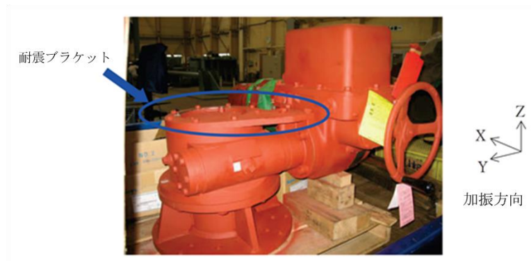
図 2.4-8 二次減速機付き電動弁駆動部（補強後）
