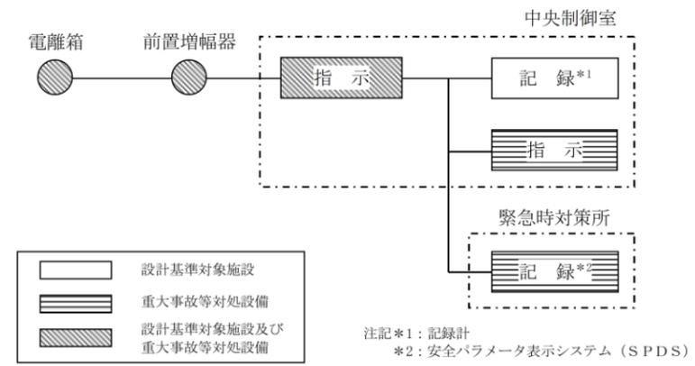
図 3-1 格納容器雰囲気放射線モニタ (ドライウエル) の概略構成
