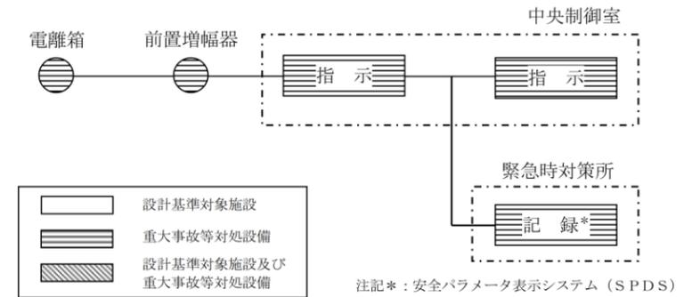
図3-8 第1ベントフィルタ出口放射線モニタ (高レンジ) の概略構成図
