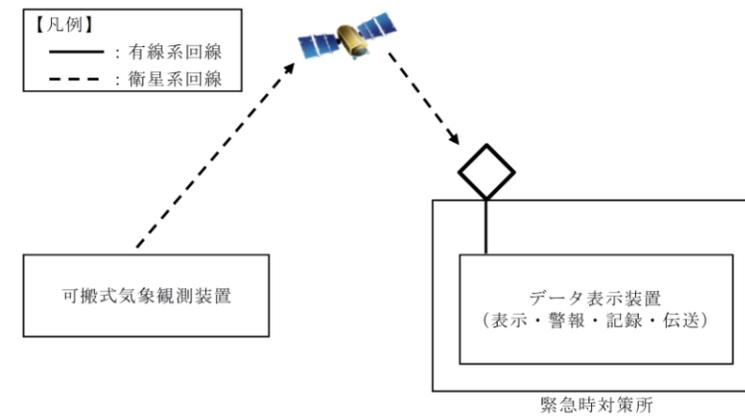
図3-32 可搬式気象観測装置の伝送概略図
