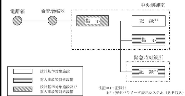
図 3-3 格納容器雰囲気放射線モニタ (サブプレッションチェンバ) の概略構成図
