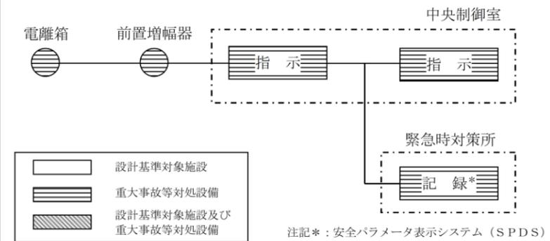
図 3-14 燃料プールエリア放射線モニタ (低レンジ) (SA) の概略構成図
