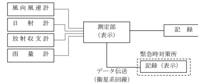
図3-31 可搬式気象観測装置の概略構成図
