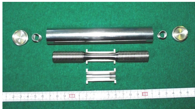
材料照射用キャプセルと照射試料の一例
