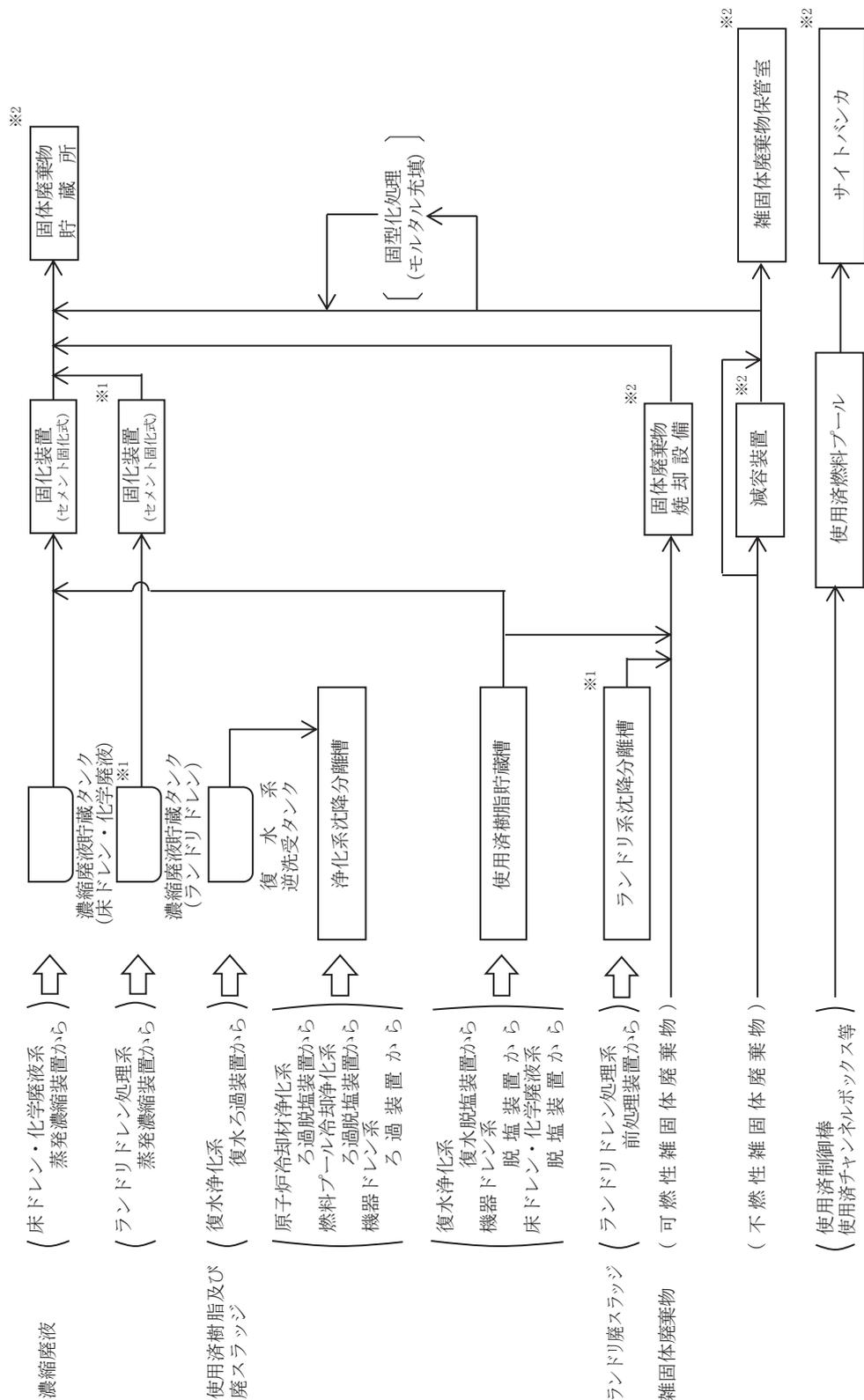
第 7.3-1 図 固体廃棄物処理系系統概要図
