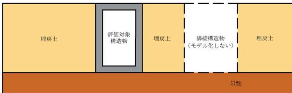
(b) 評価対象構造物と隣接構造物の間が埋戻土で埋め戻されている場合
