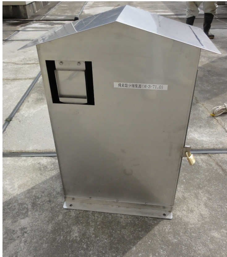
図 4. 1. 4 - 1 飛来塩分捕集器 (土研式塩分捕集器)
