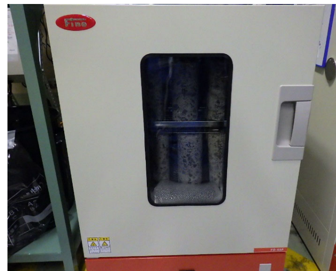
遮蔽能力の点検状況(コアサンプルの乾燥状況)
