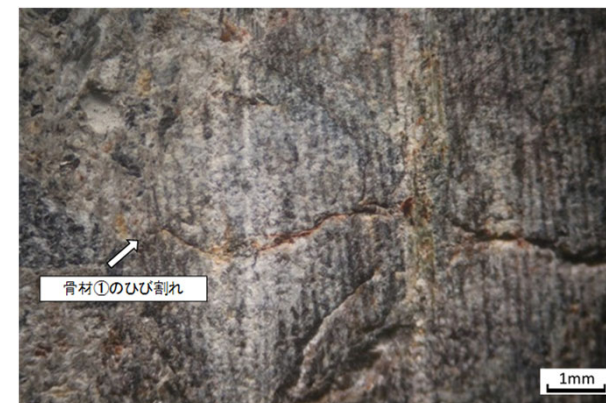
アルカリ骨材反応の点検状況(実体顕微鏡観察状況) 3号炉 タービン建屋 内壁及び床(粗骨材)※
