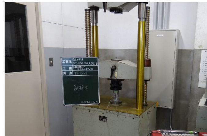
強度の点検状況
