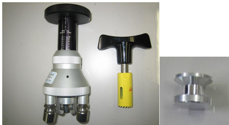
図 プルオフ法の試験機材 (左：付着性試験機、中：ドリーカッター、右：ドリー)
