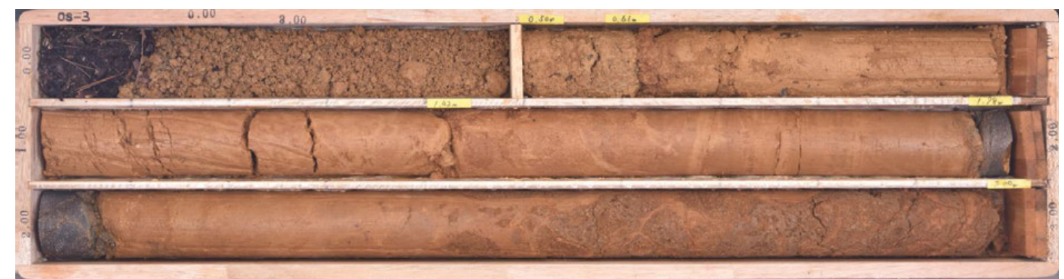
OS-3孔コア写真(0.0~3.0m, 掘進傾斜45°)
