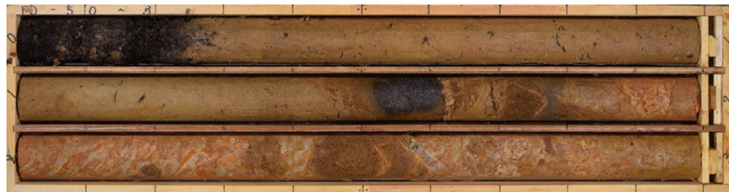
FD-5孔コア写真(0.0~3.0m, 掘進傾斜45°)
