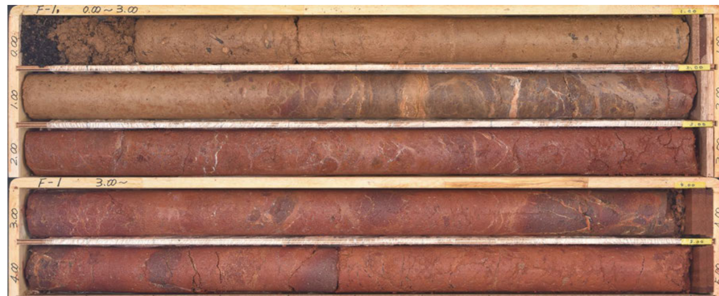
コア写真(0.0~5.0m, 掘進傾斜鉛直)
