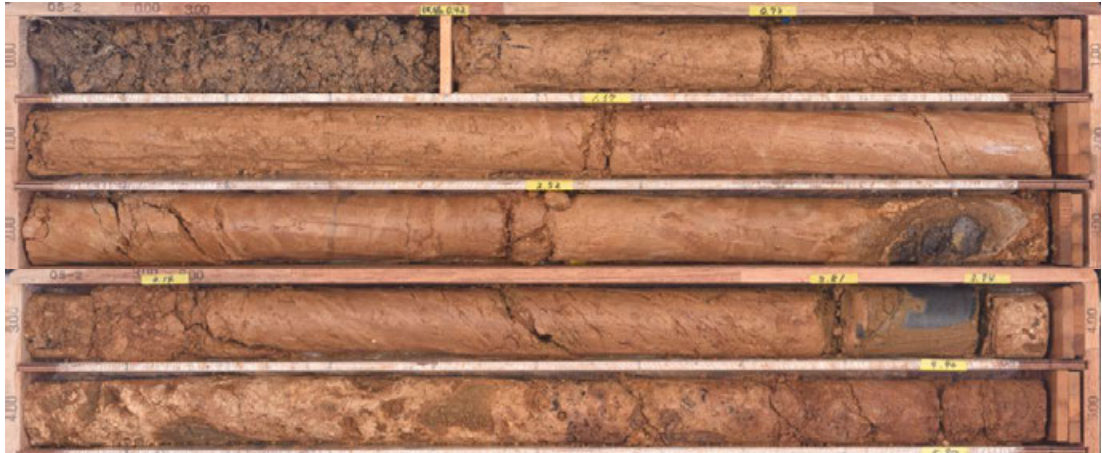
OS-2孔コア写真(0.0~5.0m, 掘進傾斜45°)
