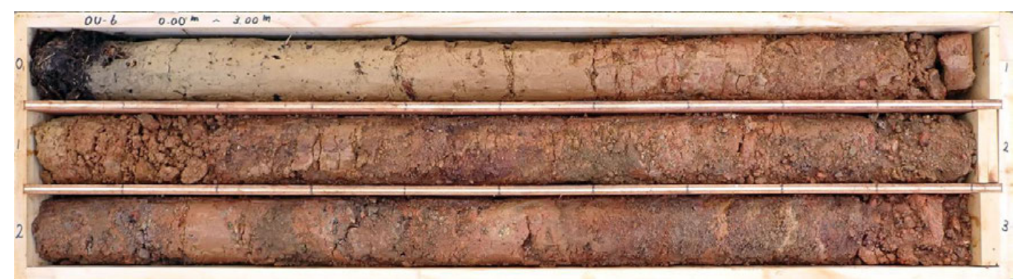
コア写真(0.0～3.0m, 掘進傾斜鉛直)
