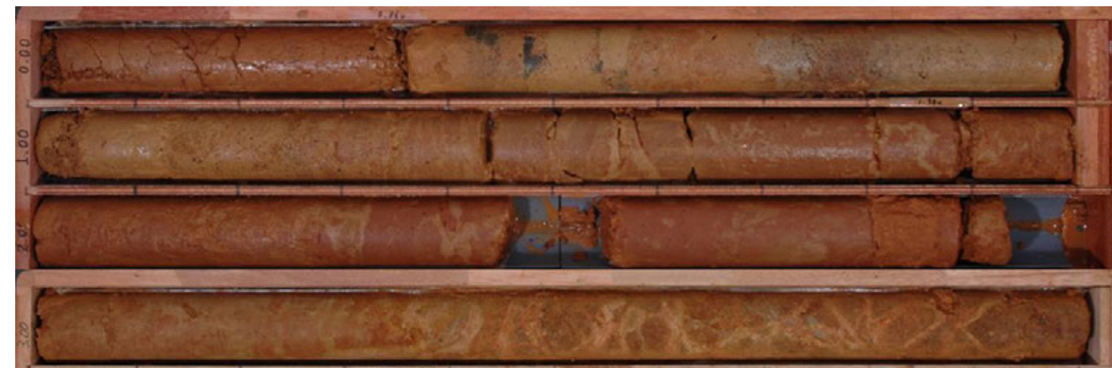
コア写真(0.0~4.0m, 掘進傾斜鉛直)
