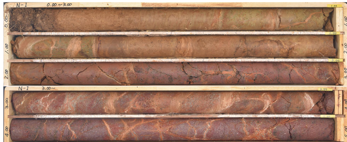
コア写真(0.0~5.0m, 掘進傾斜鉛直)
