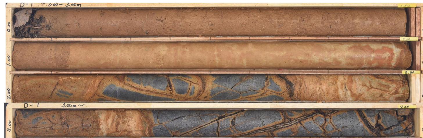
コア写真(0.0~4.0m, 掘進傾斜鉛直)
