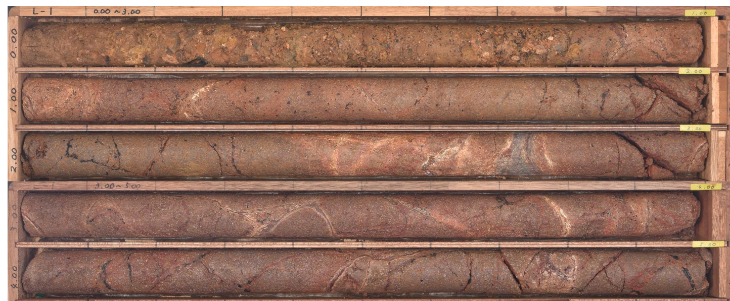
コア写真(0.0~5.0m, 掘進傾斜鉛直)
