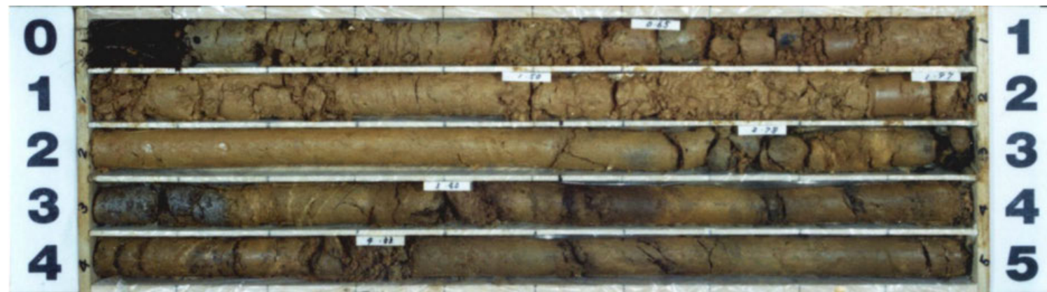
コア写真(C-13孔 0.0～5.0m 掘進傾斜鉛直)
