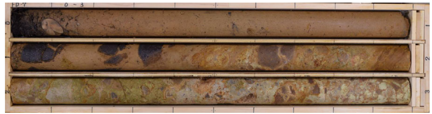
FD-7孔コア写真(0.0~3.0m, 掘進傾斜45°)
