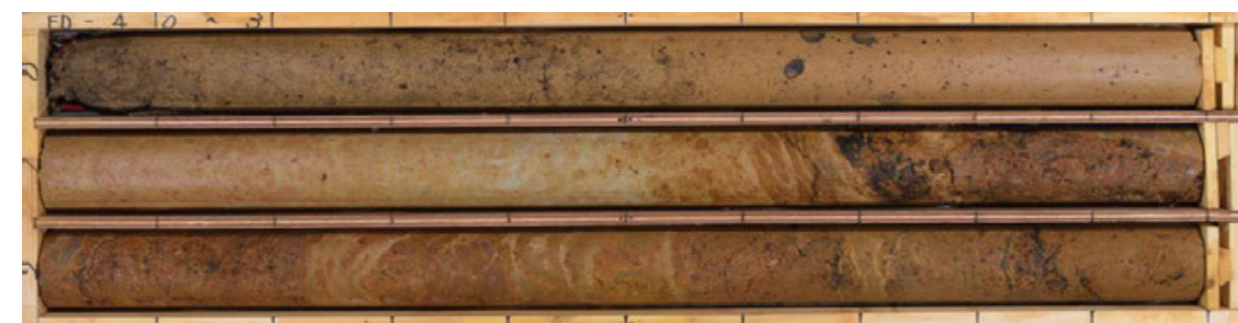
FD-4孔コア写真(0.0~3.0m, 掘進傾斜45°)
