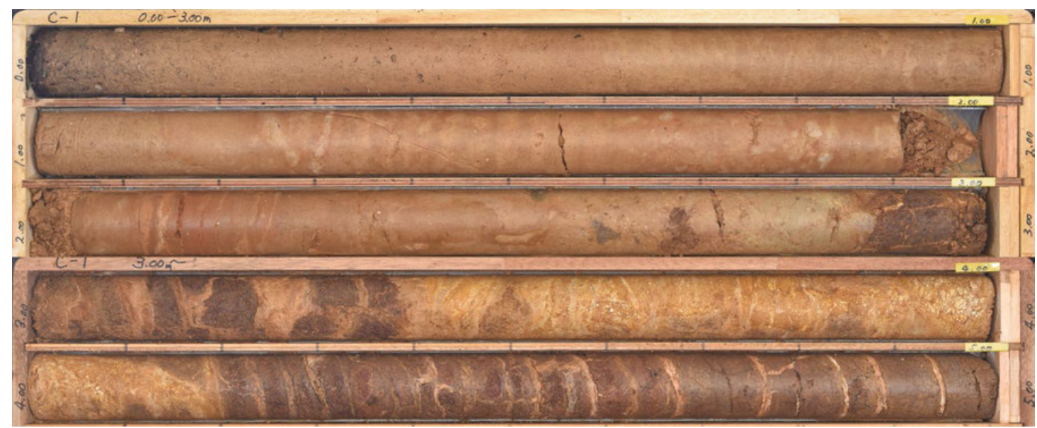
コア写真(0.0~5.0m, 掘進傾斜鉛直)
