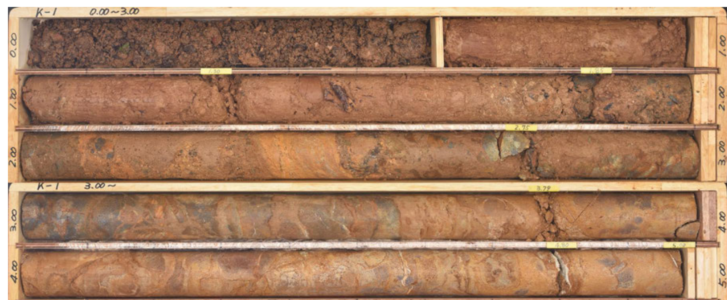
コア写真(0.0~5.0m, 掘進傾斜鉛直)
