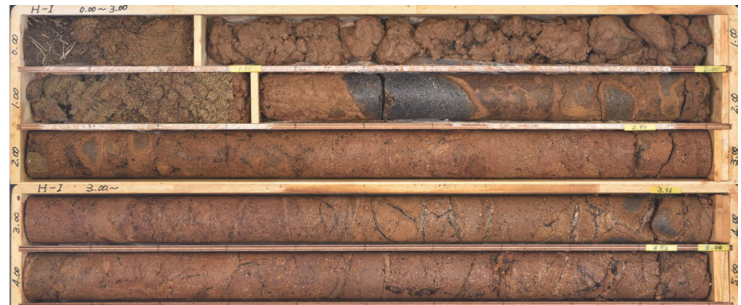
コア写真(0.0~5.0m, 掘進傾斜鉛直)
