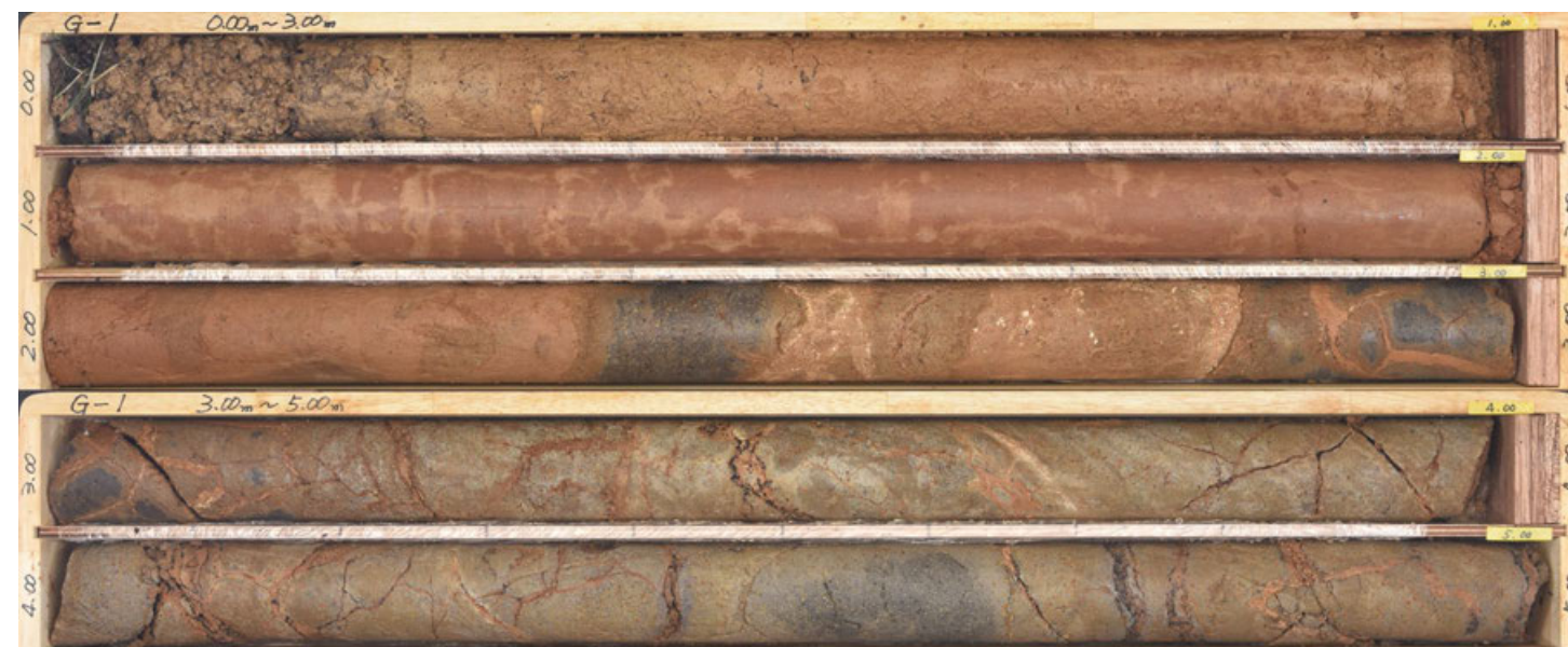
コア写真(0.0~5.0m, 掘進傾斜鉛直)
