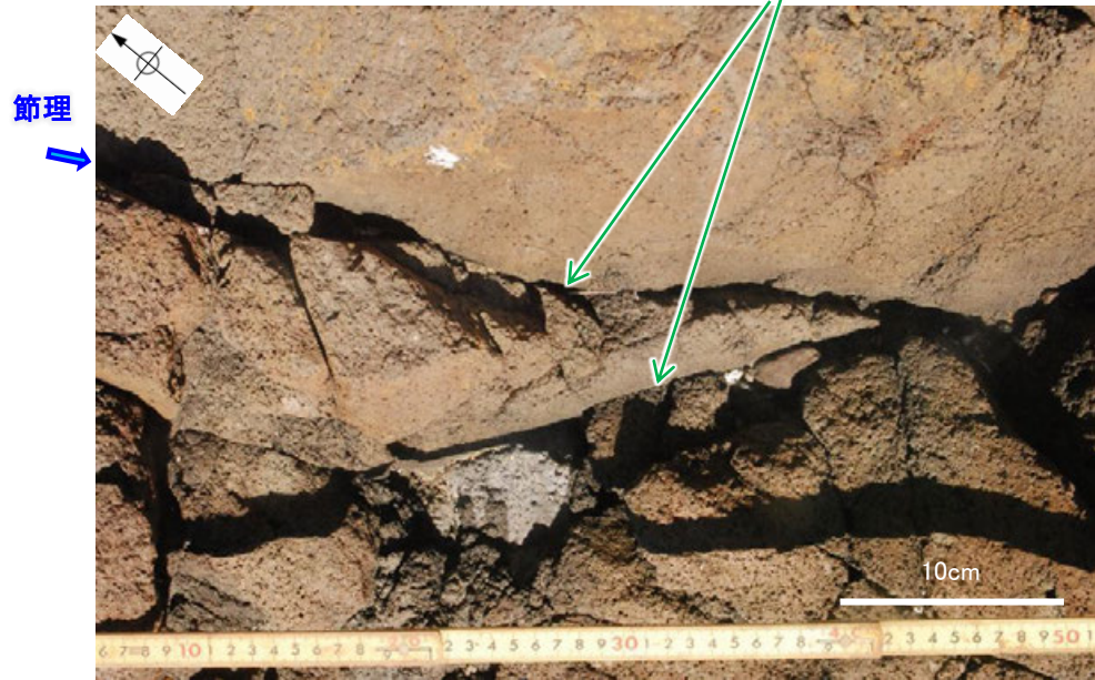
写真②拡大 谷地形(2)延長位置の不連続な節理
