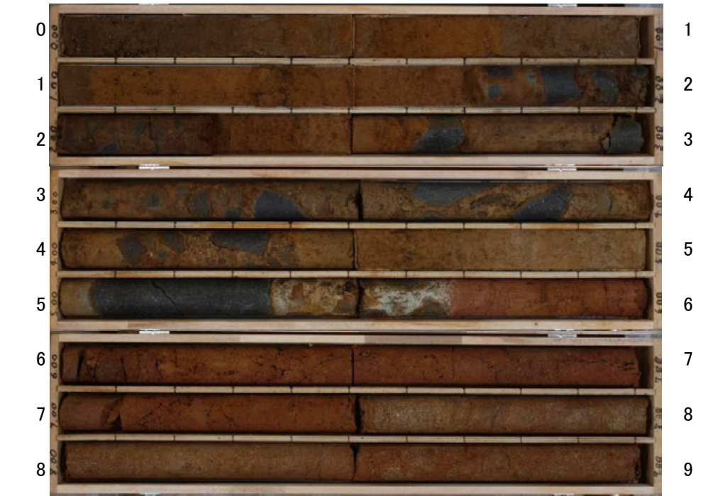
US-N05(孔口標高43.19m, 掘進長9m, 鉛直)
