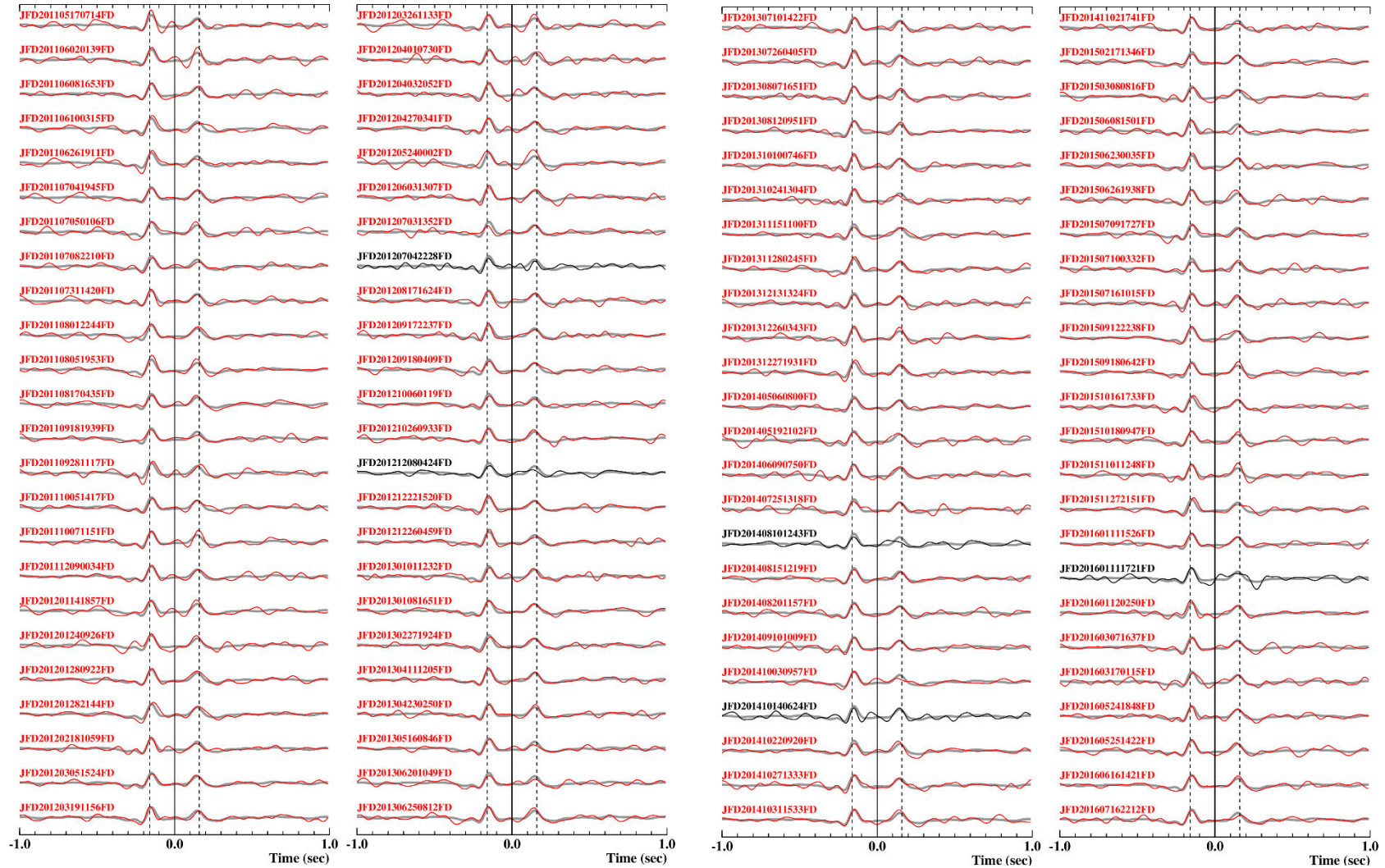
第6.4.2-2図 GL-2mに対するGL-125mの各地震のデコンボリューション波形（細線）とスタッキング波形（灰太線）（3/4）
