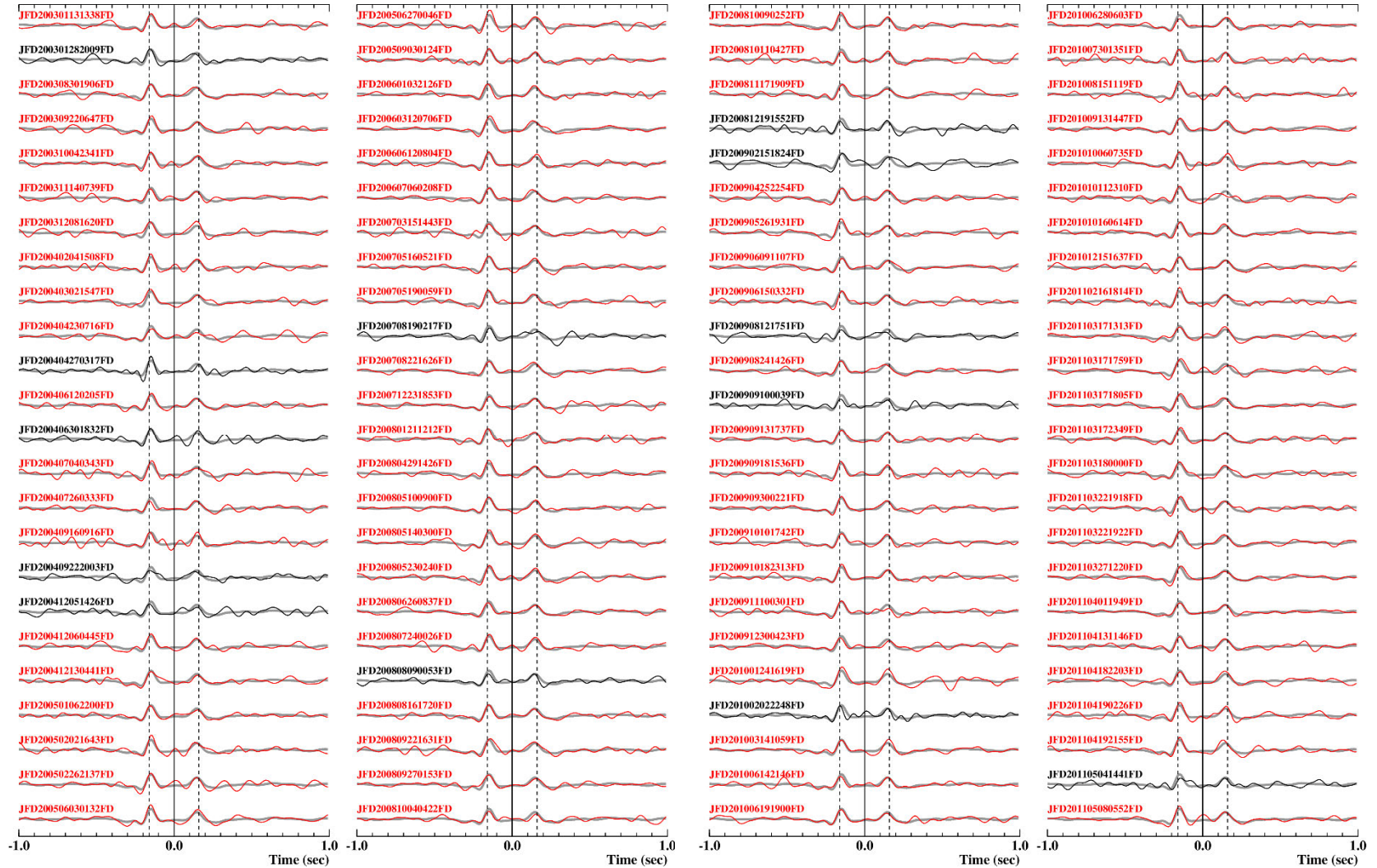
第6.4.2-2図 GL-2mに対するGL-125mの各地震のデコンボリューション波形（細線）とスタッキング波形（灰太線）（2/4）
