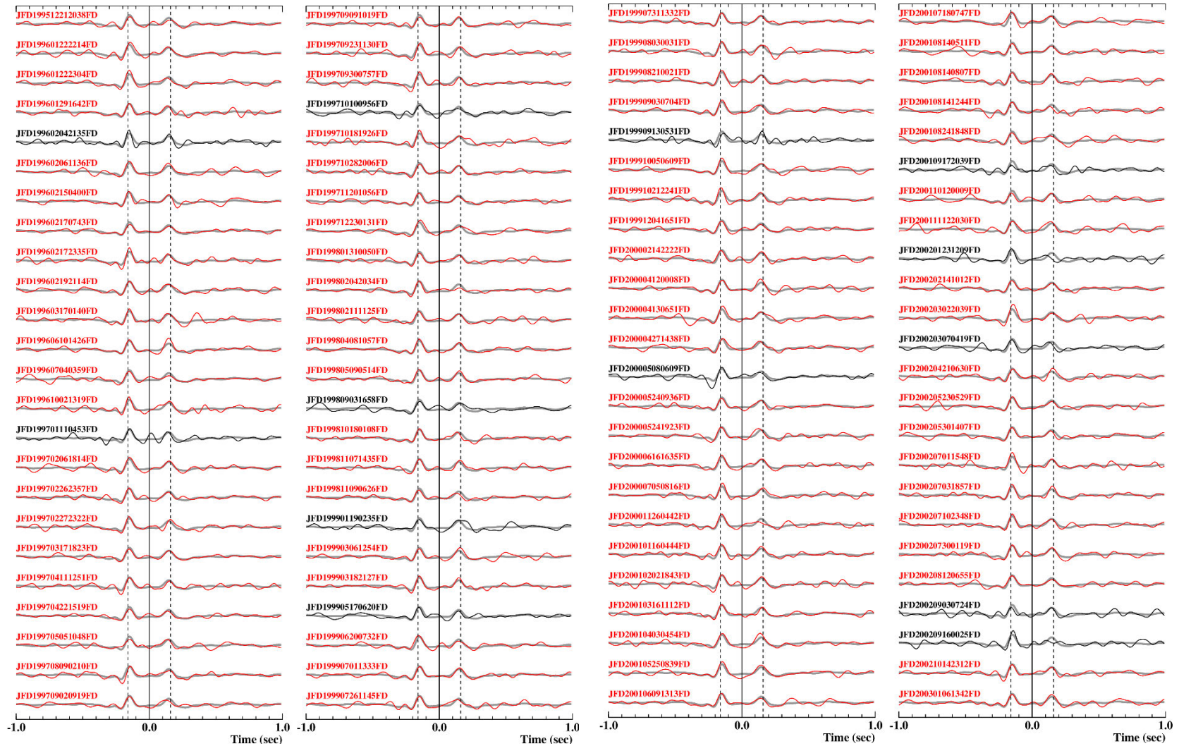
第6.4.2-2図 GL-2mに対するGL-125mの各地震のデコンボリューション波形（細線）とスタッキング波形（灰太線）（1/4）
